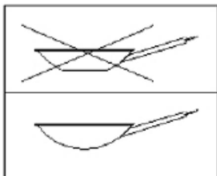
Le générateur n'accepte pas les pots inadaptés. Tout autre produit non répertorié dans ce paragraphe est automatiquement considéré comme exclu et impropre au bon fonctionnement des générateurs à induction.
