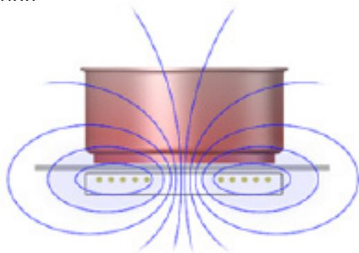
Le principe de base de la cuisson par induction est très simple. Lorsque la casserole est placée sur la surface en céramique de la table de cuisson, elle entre dans le champ magnétique généré par le système d'induction.
